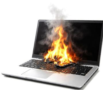
Dabei wird innerhalb kürzester Zeit eine große Energiemenge freigesetzt, wodurch extreme Temperaturen entstehen, die sämtliches brennbares Material in unmittelbarer Umgebung sofort entzünden können. Die Brandgefahr ist bereits bei der Annahme erheblich und hat in den vergangenen Jahren vermehrt zu Bränden bei der Sammlung, beim Transport sowie bei der Lagerung geführt.
